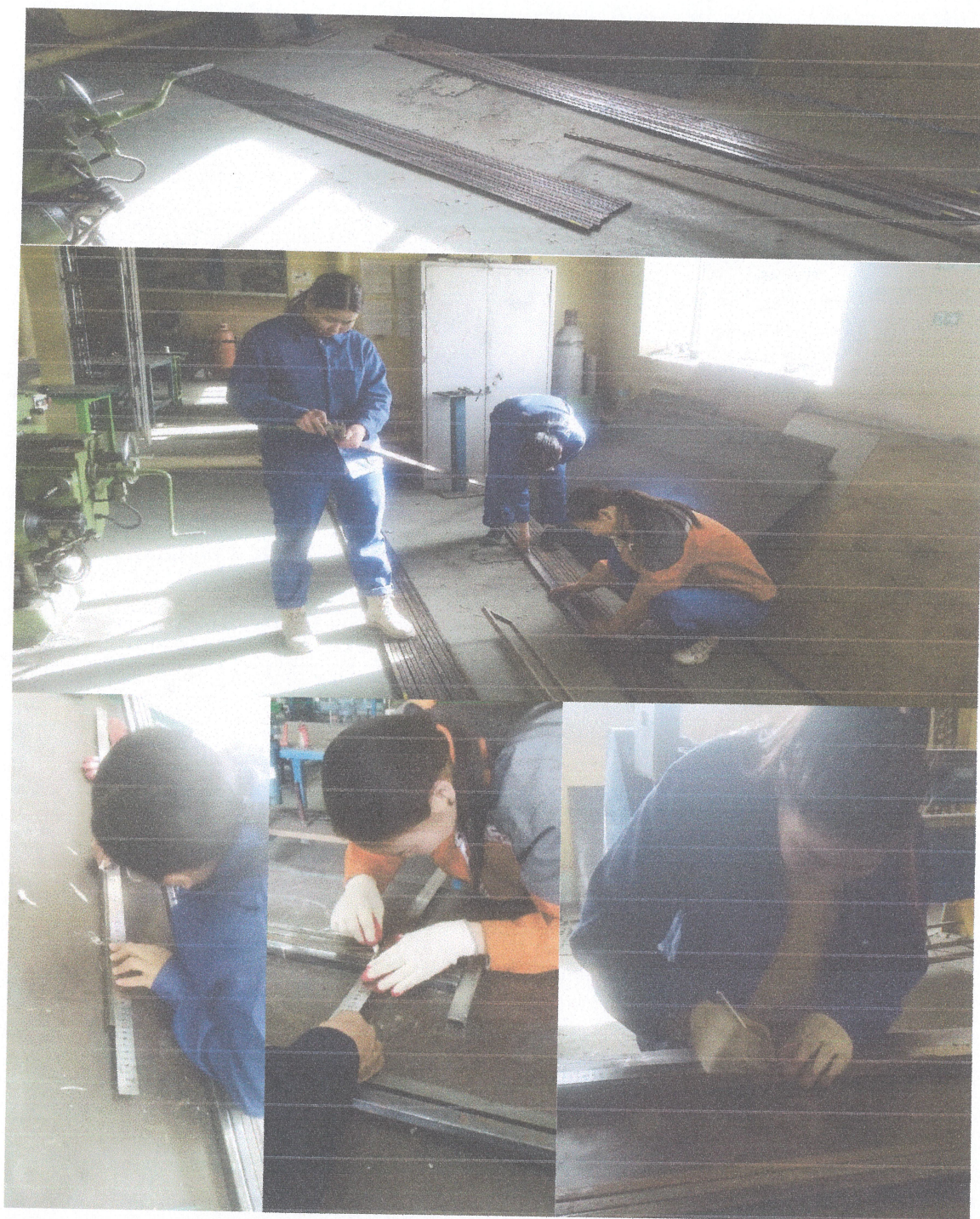
Сонгосон сэдэв болох “Зөөврийн Асар” нь үндсэн 8 багана болох 3000мм төмөр бэлдэц дээрээ зургийнхаа дагуу зуруул ,метр, шугам,тэгш өнцөгт ашиглан 1940 мм хэмжээ тавин зурж байна.
