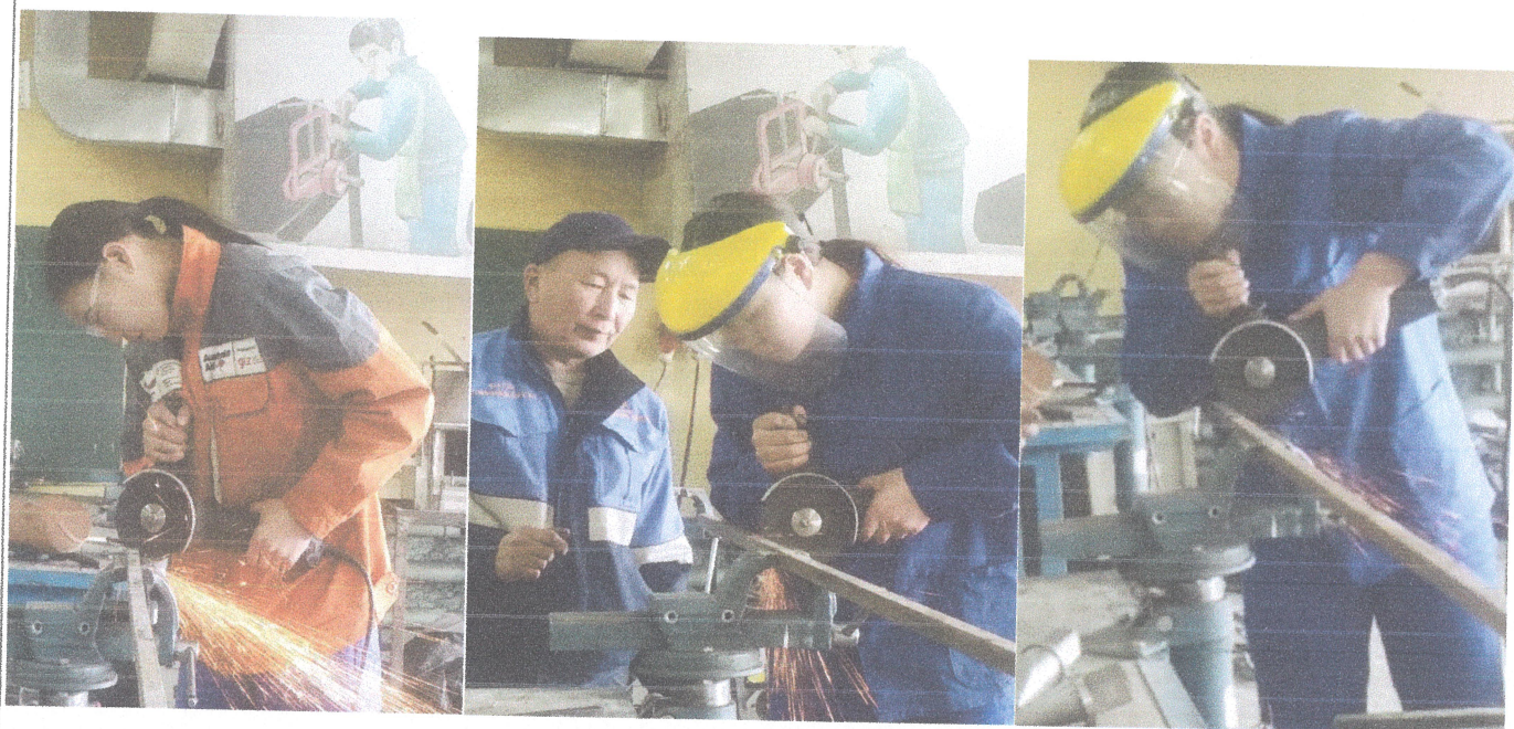
Баганын хэсэг болох 1940 мм болгон хэмжээ тавьсан хэсгээрээ гар ажиллагаатай цахилгаан тасдагч ашиглан тасдаж байна.
