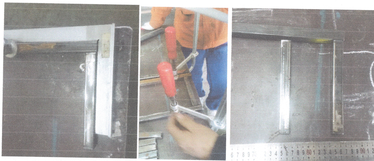
Баганын бэхэлгээний хөндлөн хэсэг болох тушааны урт нь 3340мм урттай байх ба 3000 мм төмөр бэлдэц дээрээ 340мм нэмэж тэгш өнцөгт, зуруул, шугам, ашиглан зурж цахилгаан гар тастагч ашиглан тастаж тэгш өнцөгт ашиглан гагнасан.
