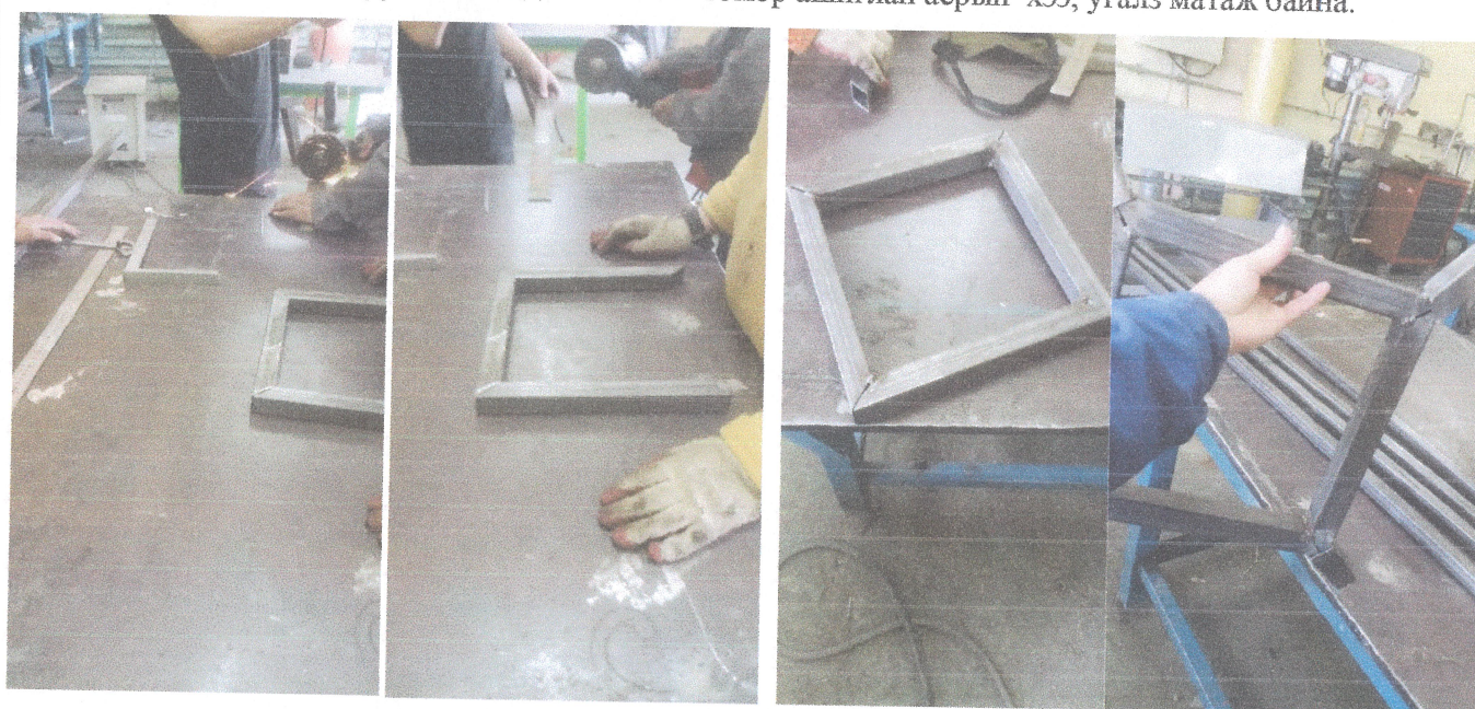
Асрын орой хэсэг болох бэлдэц төмөр дээрээ хэмжээ тавин холбон гагнаж байна.
