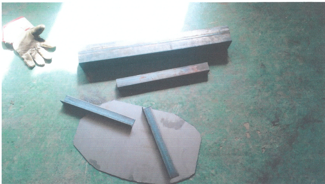
Цэгэн гагнуурын аппарат суурь хавтан, гол тулгуур, дээд гарны тулгуур, тавиур тасдаж бэлэн болгосон байгаа нь
