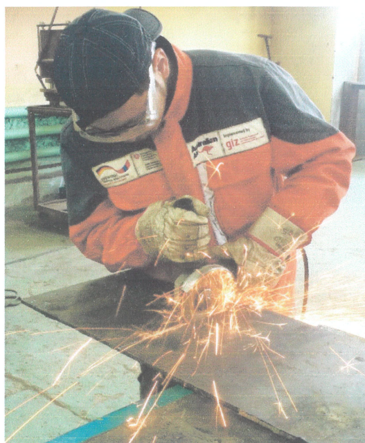
Трансформаторын тагийг тасдаж, хайчилж байна
