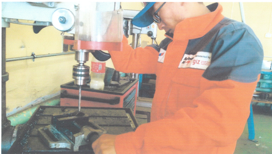
Зэсэн хошуугаа боох трубагаа өрөмдөж байна
