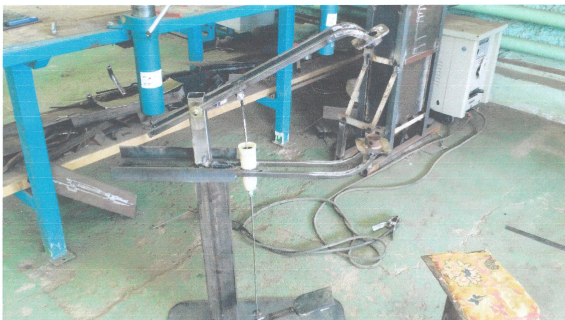
Цэгэн гагнуурын аппаратын дээд гар болон педалыг холбож угсарснаар педал дээр гишгэхэд дээд гар доод гартай нийлнэ.
