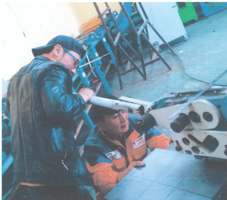
Трансформаторын тагийг тасдаж, хайчилж байна
