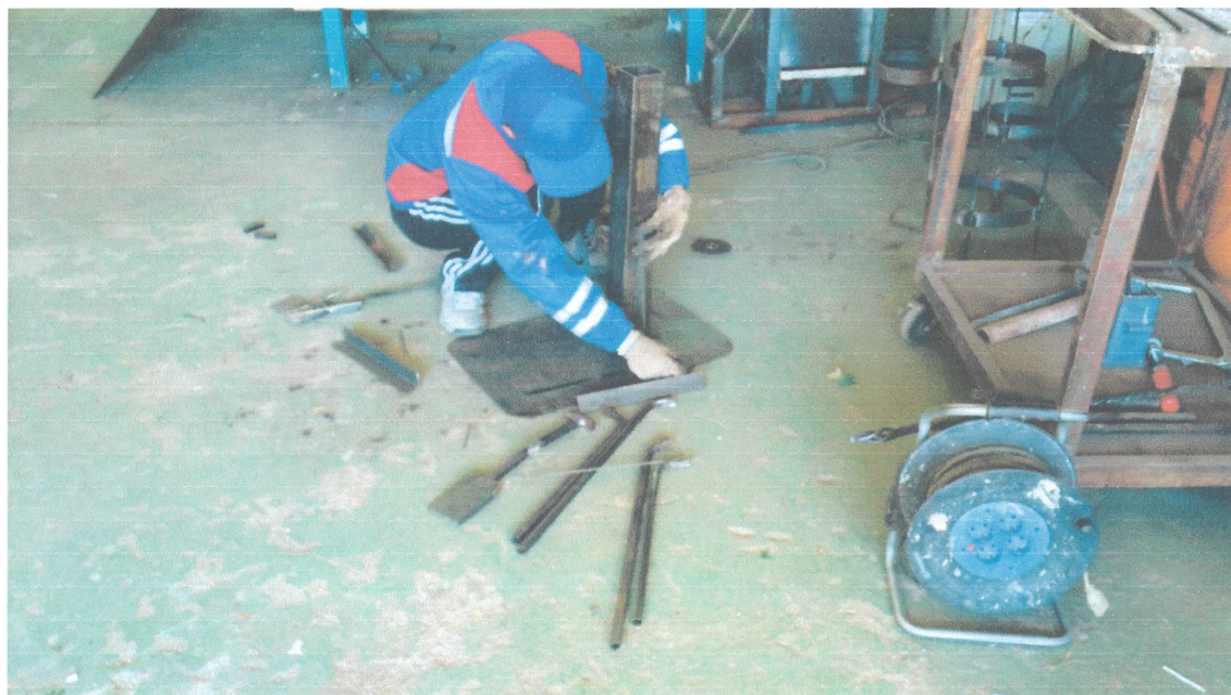
Тайрч тасдсан эд ангиудын хэмжээг шалгаж байна
