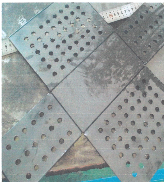
Трансформаторын тагийг тасдаж, хайчилж байна
