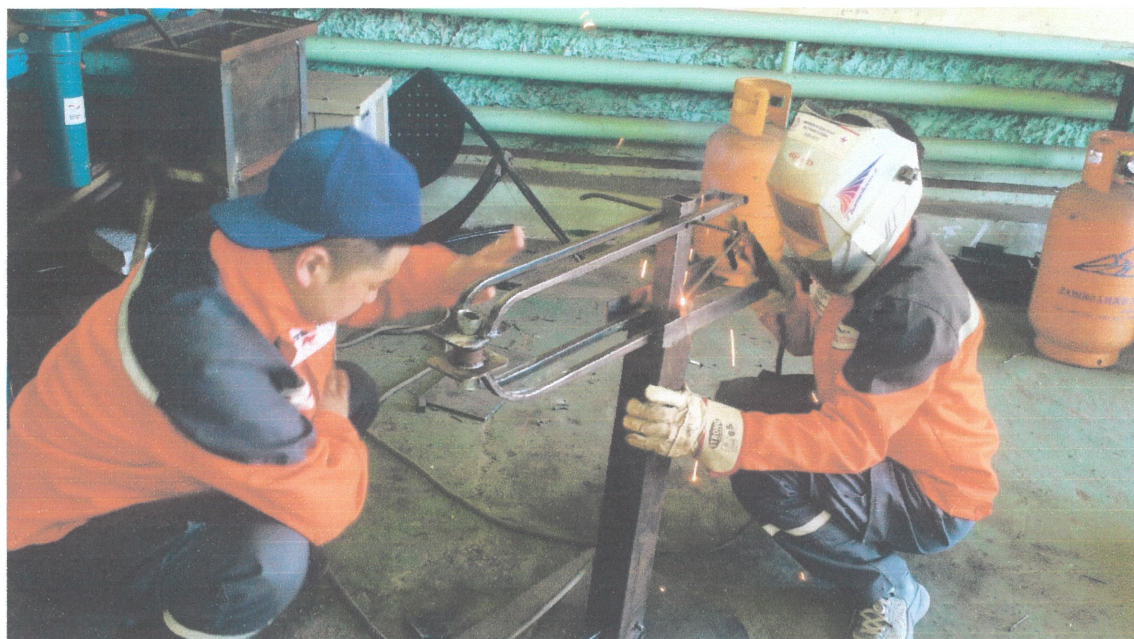
Дээд болон доод гараа тааруулж дээд гарын тулгуурыг гагнаж байна
