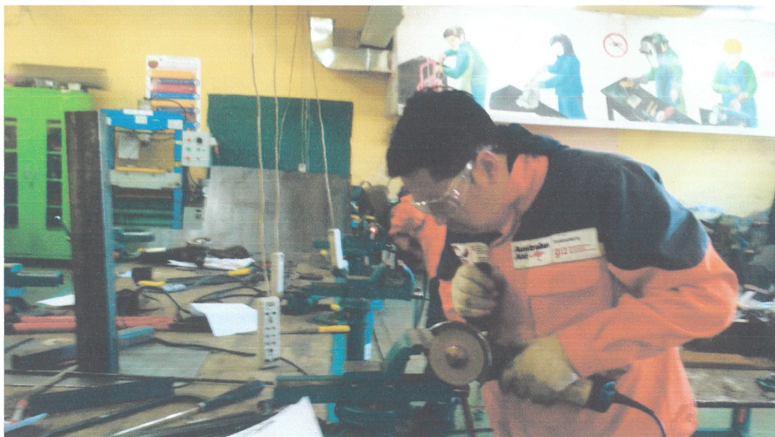
Цэгэн гагнуурын аппарат суурь хавтан, гол тулгуур, дээд гарны тулгуур, тавиур тасдаж бэлэн болгосон байгаа нь
