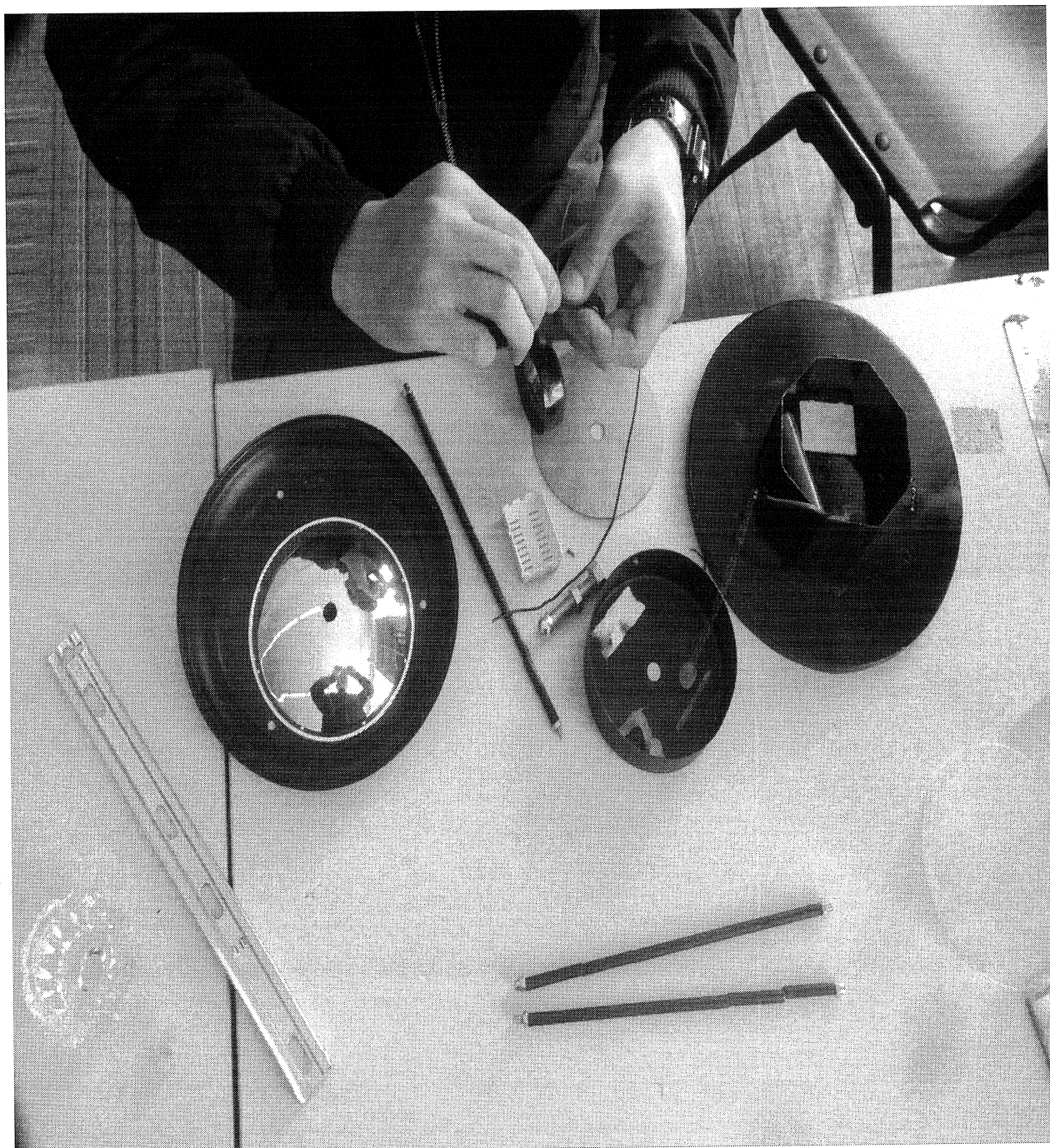
Хавсралт 9 Их биеийг гагнаж, угсарч, будгийн ажил явуулсаны дараа гэрэлтүүлэгний холболтыг холболтын хайрцганд хийнэ.
